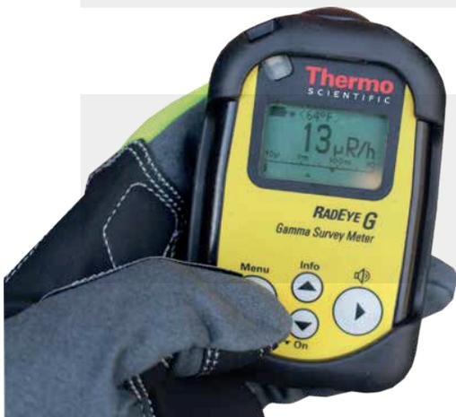
Se puede acceder fácilmente a todas las funciones esenciales incluso con guantes protectores. El LED de alarma puede verse mientras se lleva el equipo en una funda de cinturón. El instrumento también incorpora un vibrador y una salida de auriculares para una alarma silenciosa o para uso en un ambiente muy ruidoso.
